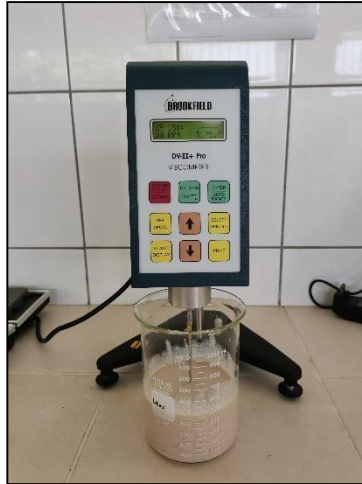
Figura 7: Medición de la viscosidad con réómetro Brookfield
