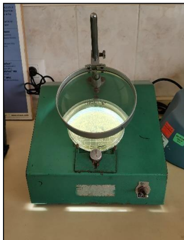
Figura 6: Recuento de bacterias ácido lácticas en contador Quebec
