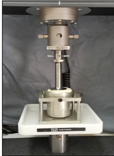
Figura 10: Medición de la dureza en texturómetro Instron
