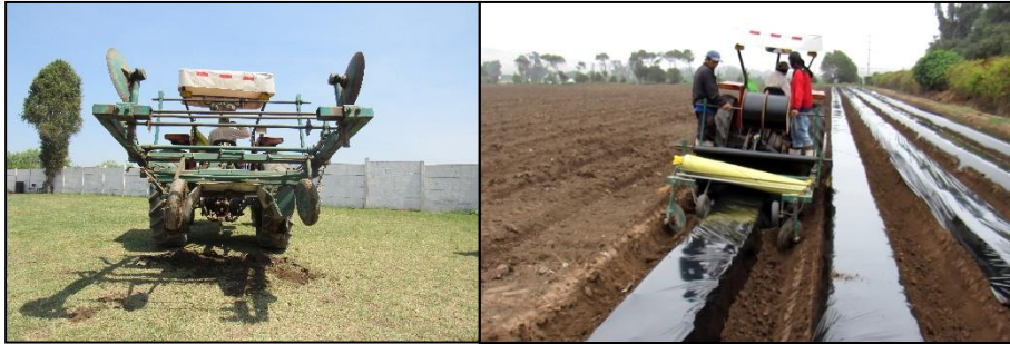
Figura 16: Implemento para formar los camellones e instalación
