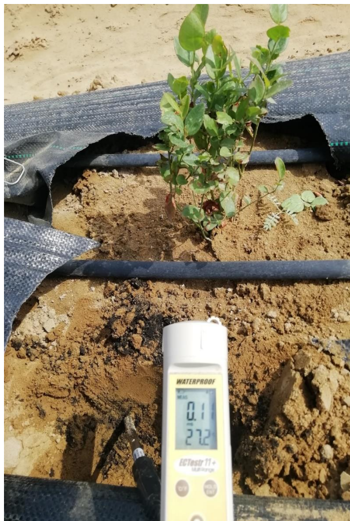
Figura 17: Medición de CE y temperatura de suelo en un campo de arándano recién plantado.
