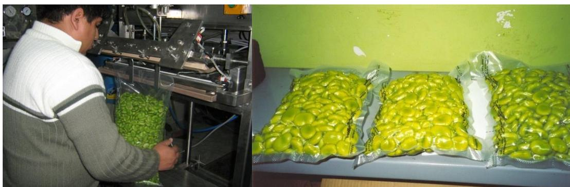
**Figura 24. Pruebas de envasado al vacío – Haba grano verde**
