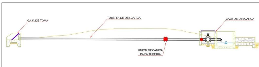
*Figura 6: Vista de perfil de tubería de descarga. Tomado del plano de estructura de descarga por la Unidad Ejecutora "Fondo Sierra Azul", 2020, Expediente técnico de inversión "Construcción de captación de agua; en el(la) recarga hídrica para 12 unidades productoras de los sistemas de riego en el distrito de Huamanquiua, provincia Víctor Fajardo, departamento Ayacucho".*
