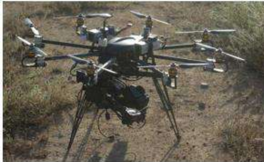
Figura 3: RPA de tipo ala rotatoria o multirrotor
