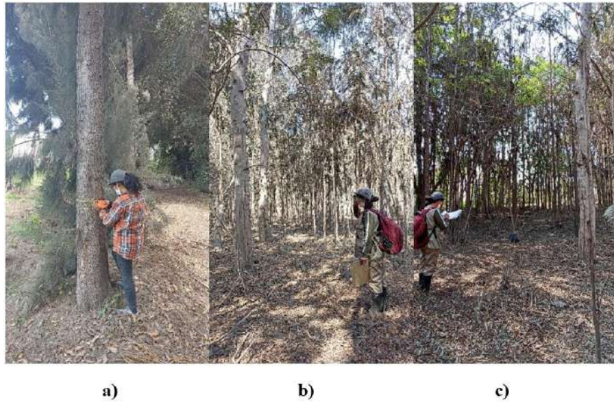
Figura 57: Toma de datos con a) cinta diamétrica, b) hipsómetro y c) libreta de campo, en la zona de vegetación densa
