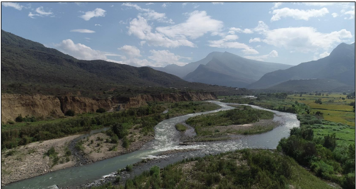
Figura 18: Zona con alta carga de sedimentos y presencia de cauce entrelazado o trenzado
