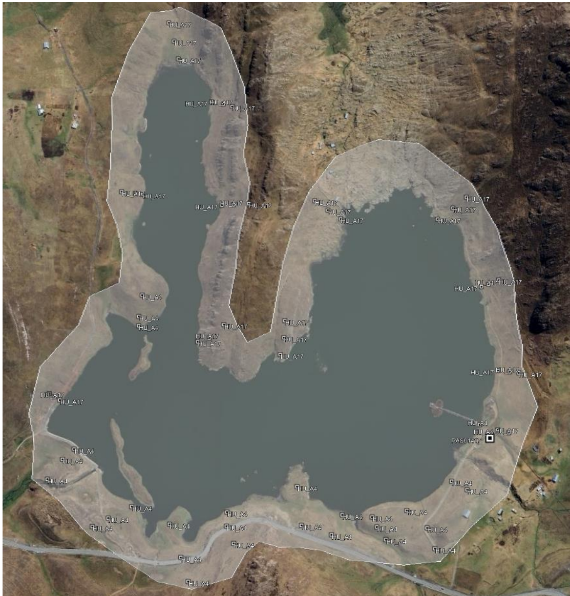
Figura 9: Esquema de levantamiento fotogramétrico de lagunas
