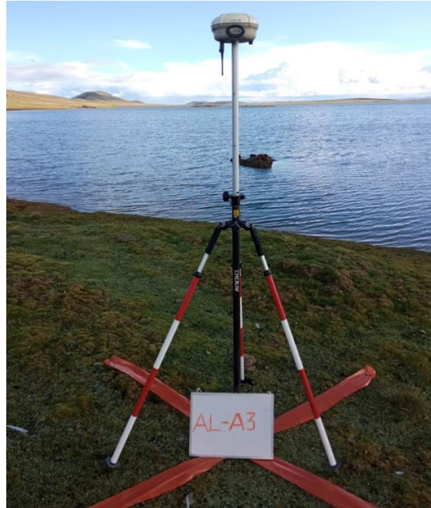
Figura 17: Punto de fotocontrol siendo levantado por el GPS Diferencial Trimble – rover en la laguna Alcacocha
