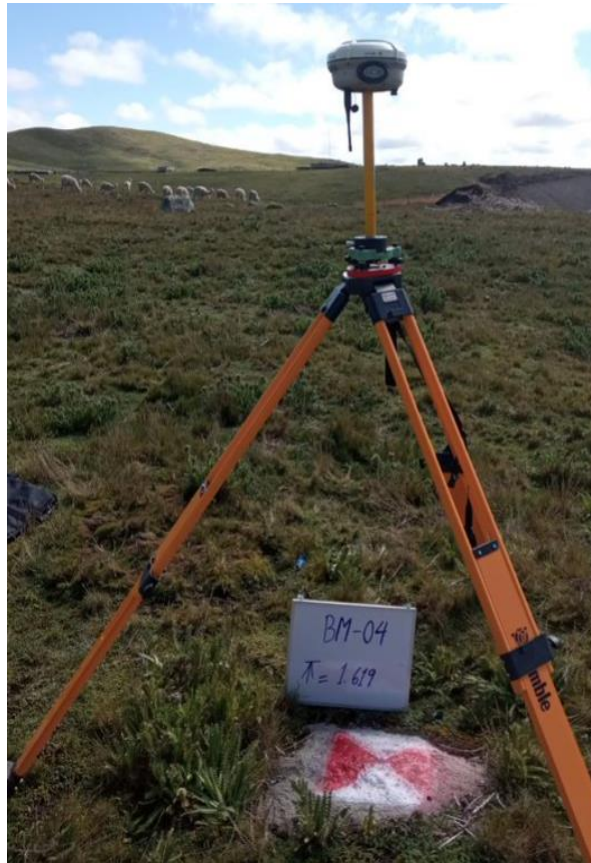
Figura 53: Levantamiento de punto base BM-04 ubicado en la laguna Acococha
