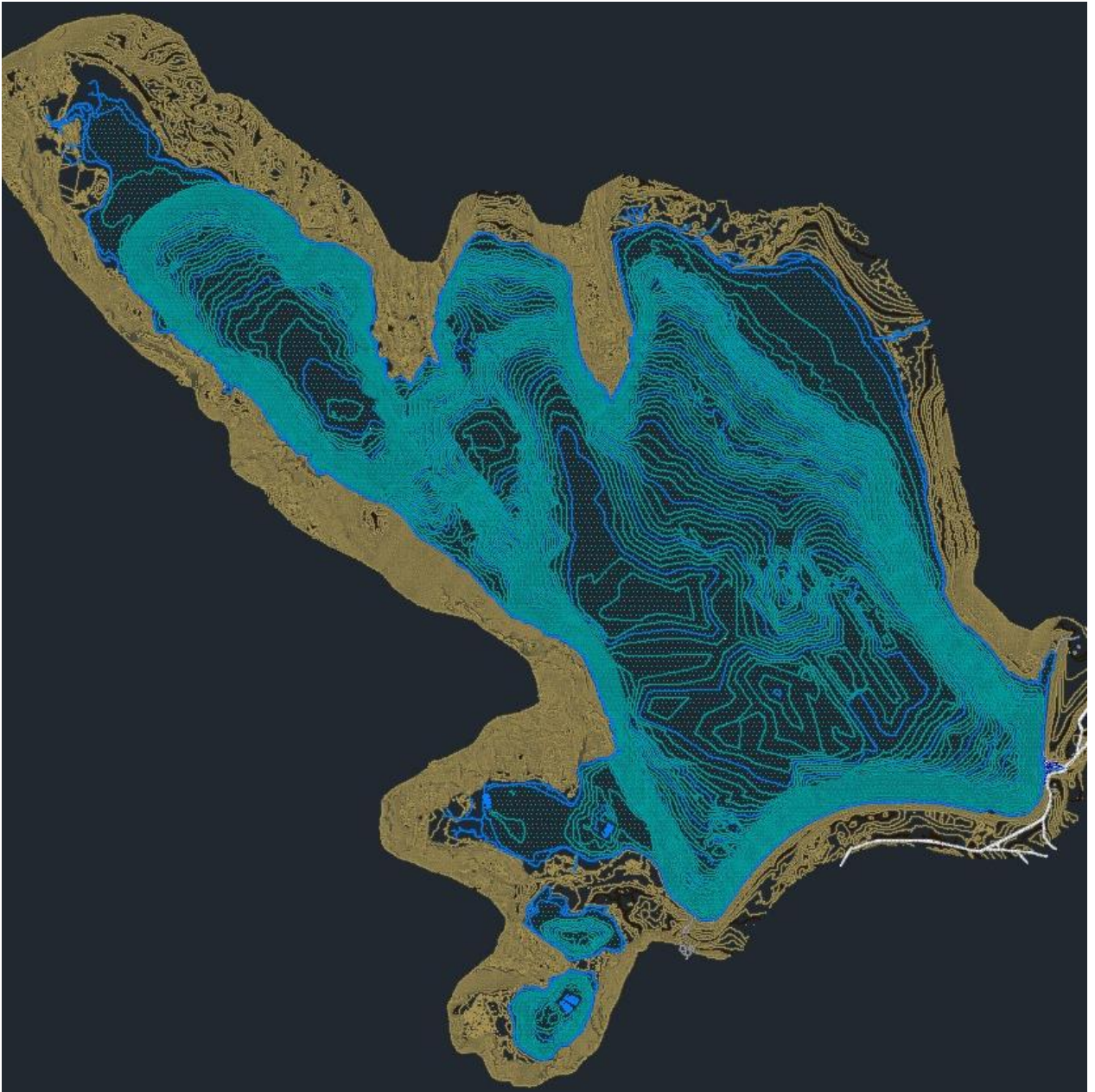
Figura 117: Topografía generada de la fotogrametría y batimetría de la laguna Acococha
