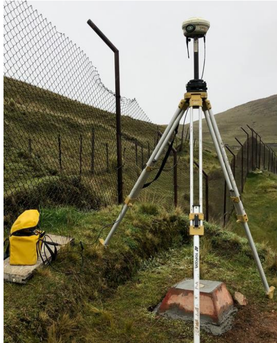
Figura 51: Levantamiento de punto base PAS-01417 ubicado en la laguna Huicra
