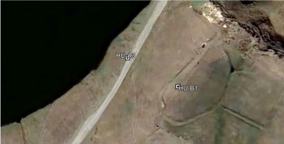
Figura 18: Posición final de puntos de fotocontrol ubicados - pendiente baja
