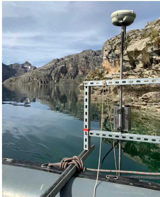
Figura 22: Vista fotográfica de los equipos GNSS-Diferencial (rover) y ecosonda sobre estructura metálica en la embarcación para el levantamiento batimétrico
