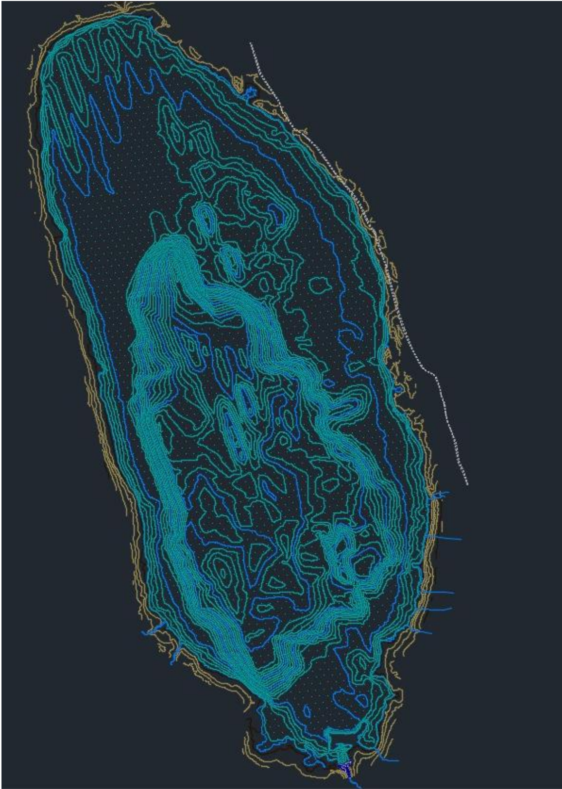
Figura 119: Topografía generada de la fotogrametría y batimetría de la laguna Alcacocha
