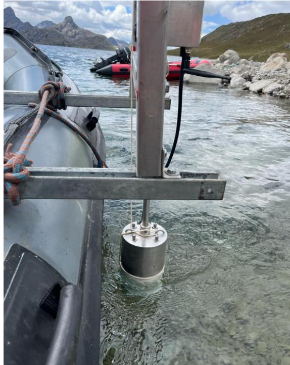
Figura 5: Ecosonda ADCP M9 de la marca Sontek instalada en el soporte acoplada a un bote
