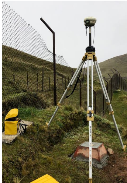
Figura 13: Instalación del GNSS diferencial para el trabajo de levantamiento de un punto base en la Laguna Huicra
