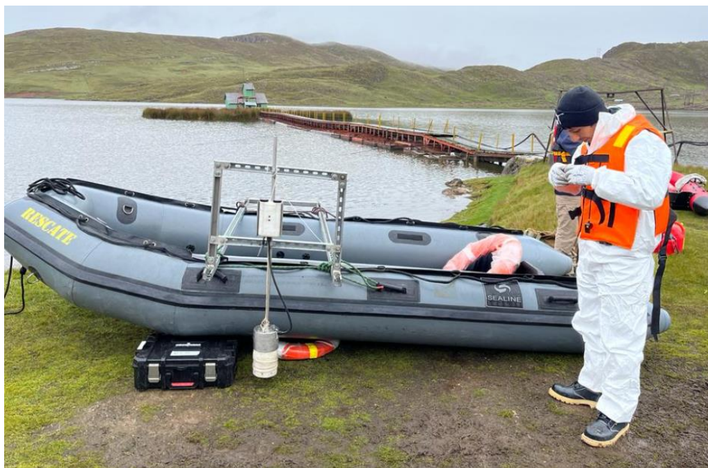
Figura 41: Armado de la estructura soporte de los sensores del bote
