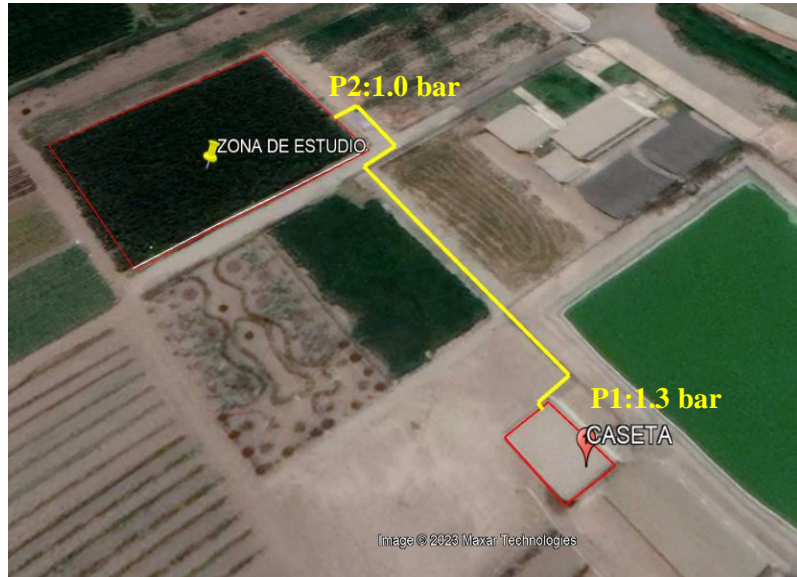
Figura 40: Presión de trabajo del sistema de riego
