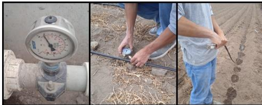
Figura 39: Medición de la presión en el porta lateral
