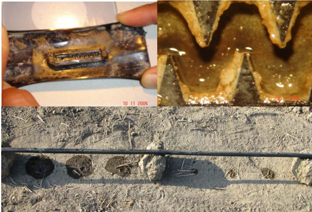
Figura 23: Taponamiento de goteros por exceso de SS. Se muestra el detalle del colapso del “serpentin” del gotero. Además, se muestra la notable diferencia entre las emisiones de cada gotero, causada por lo anterior mencionado.
