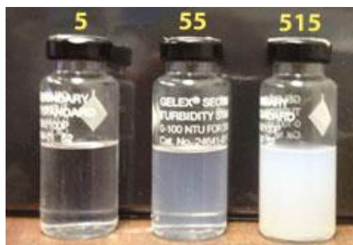
Figura 2: Suspensiones con valores de 5, 55, y 515 NTU.
