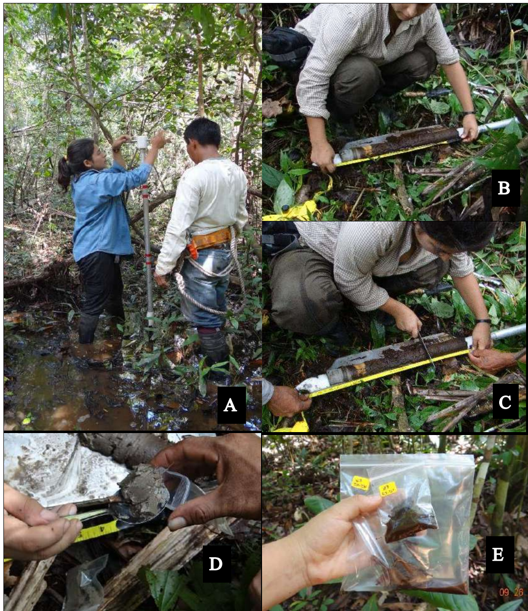
(A) introducción del barreno tipo ruso perpendicular al suelo; (B) extracción de muestra y observación del perfil; (C) seccionamiento para extracción de muestras para determinación de densidad aparente y concentración de carbono; (D) almacenamiento de muestras en bolsa hermética; (E) rotulado.
