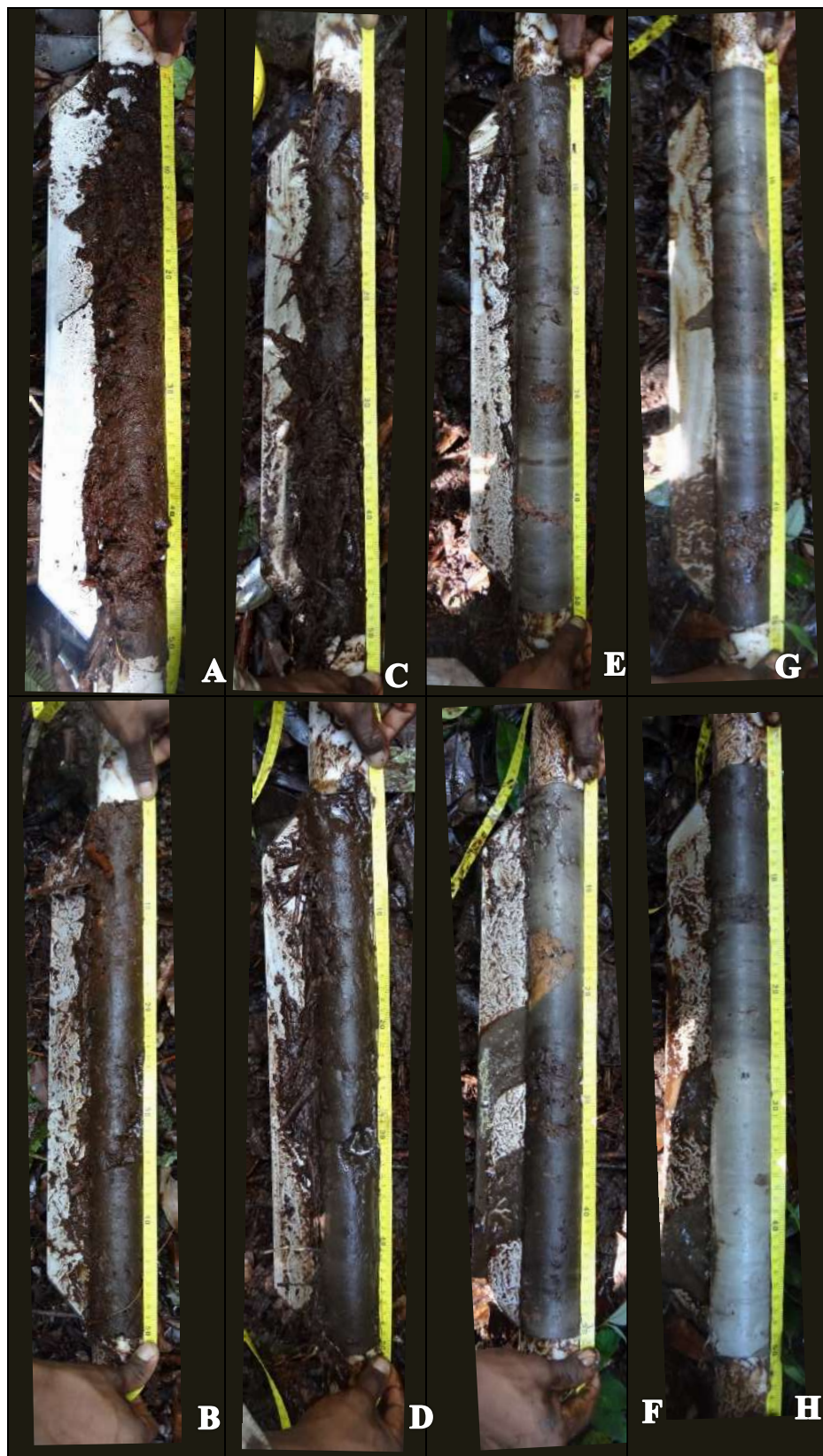
Perfil del suelo de Aguajal en Miraflores (MIR03), sub parcela número 1, con profundidad alcanzada de 387cm, con presencia de zonas de turba arcillosa.
