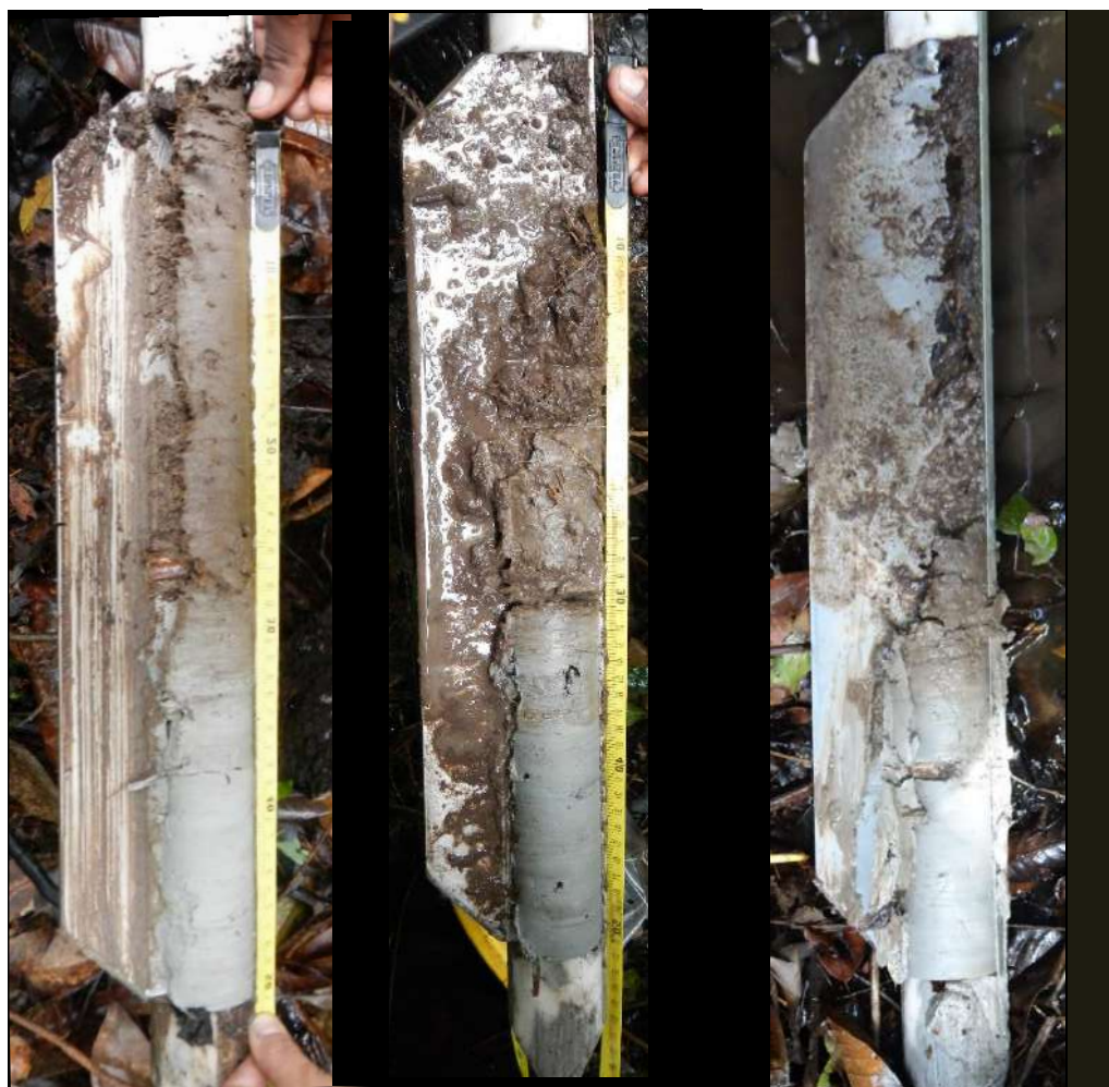
Perfil del suelo de Aguajal en la parcela JEN15 al cansado solo el 0.5m del perfil hasta llegar a la zapa arcillosa. (A) JEN15 sub parcela 1 (B) JEN15 sub parcela 8 (C) JEN15 sub parcela 15, no se obtuvo muestra a la no presencia de suelo orgánico.
