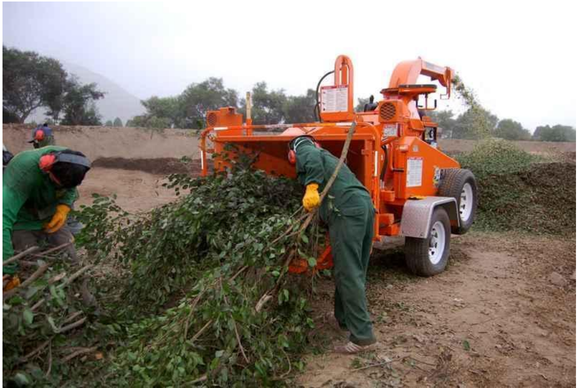
Figura 2: Proceso de chipeado de malezas en el distrito de La Molina para obtener el material que será compostado.
