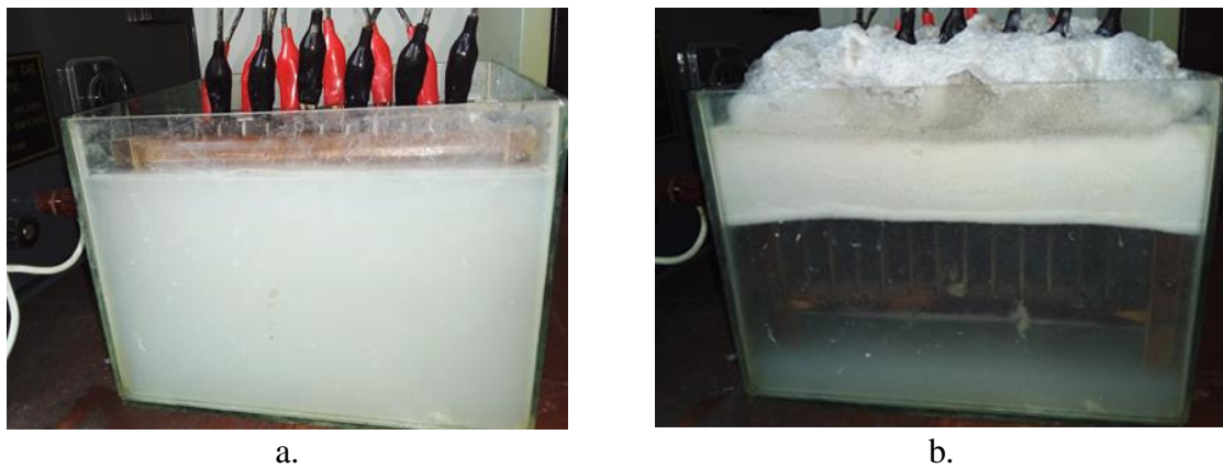
Figura 17. Electrocoagulación con electrodos de aluminio-aluminio a) Antes del tratamiento, b) Después del tratamiento
