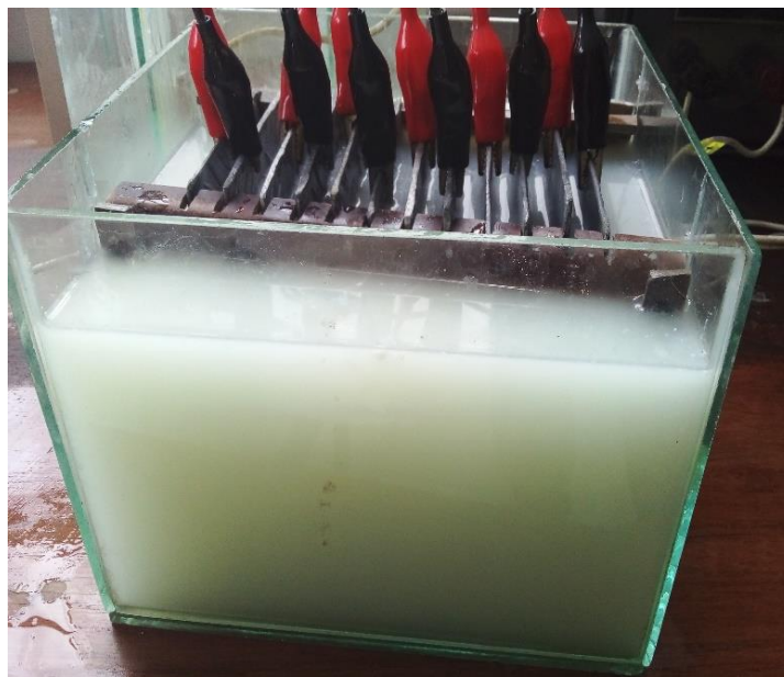
Figura 14. Celda de electrocoagulación antes del tratamiento
