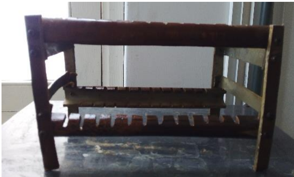
Figura 13. Soporte de las placas metálicas
