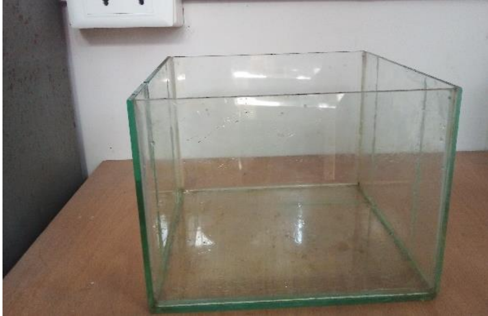
Figura 12. Celda de electrocoagulación
