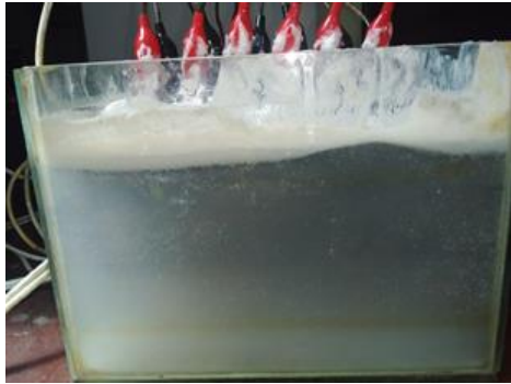
Figura 22. Electrocoagulación con intensidad de 5A a) 0 minutos, b) 10 minutos, c) 20 minutos, d) 30 minutos
