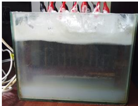
Figura 23. Electrocoagulación con intensidad de 7A a) 0 minutos, b) 10 minutos, c) 20 minutos, d) 30 minutos
