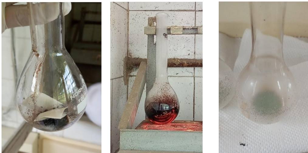
Figura 4: Balón micro Kjeldahl con muestra vegetal, catalizador y \text{H}_2\text{SO}_4 antes, durante y después de la digestión
