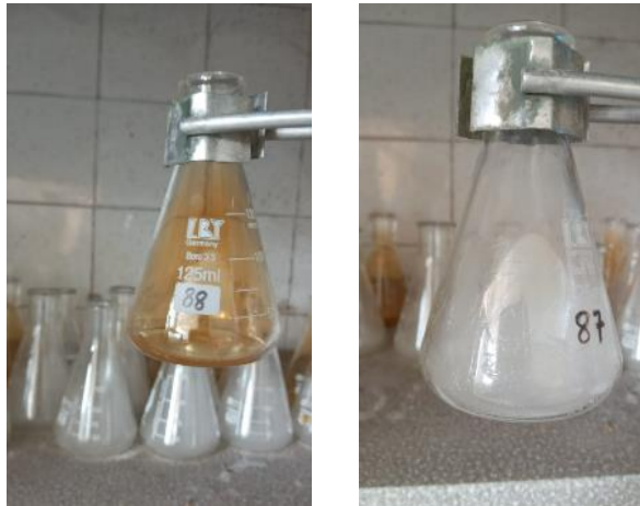
Figura 6: Proceso de digestión húmeda
