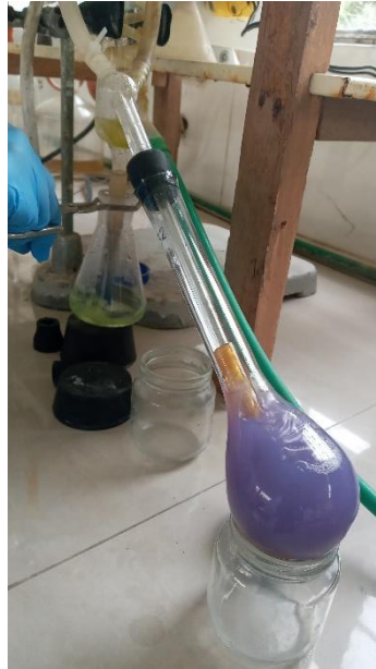
Figura 5: Destilación de muestra digerida con NaOH al 50 %
