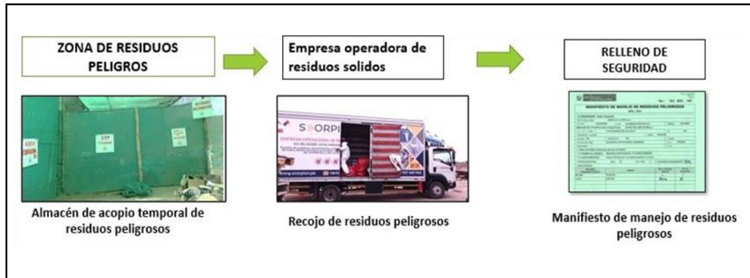
Figura 19: Proceso de disposición final de residuos peligrosos
