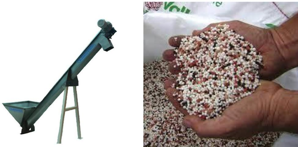
**Figura N° 4.** Equipo para el mezclado de fertilizantes (FERTIABONO)
