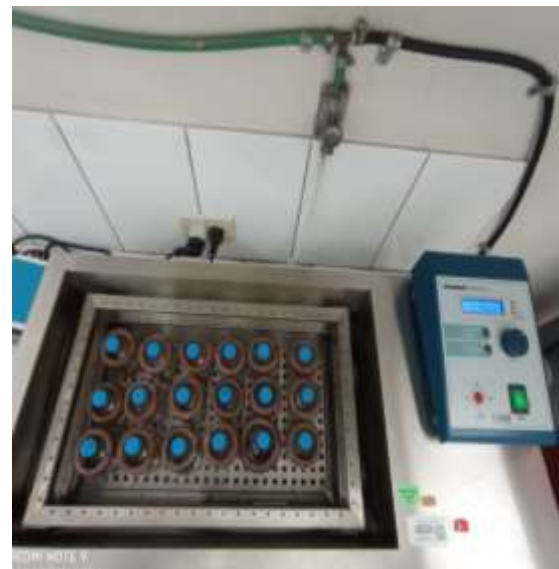
Figura 18. Incubación de los tratamientos experimentales en baño maría para la determinación de la producción de gas y metano
