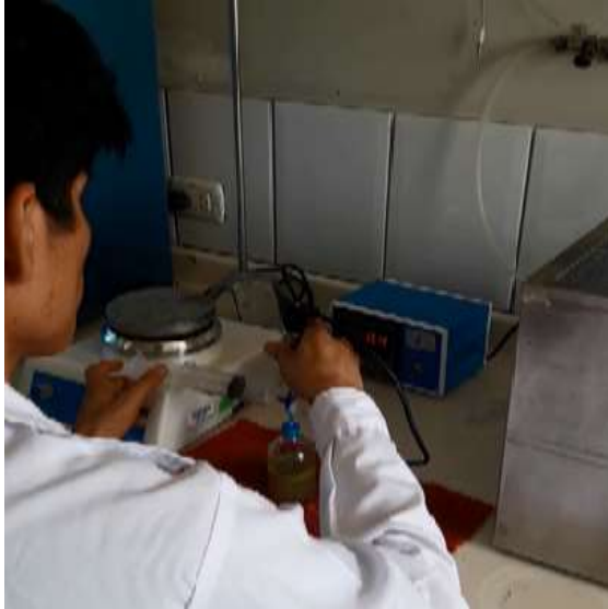
Figura 19. Cuantificación de la producción de gas utilizando una válvula de 3 vías y un transductor de presiones
