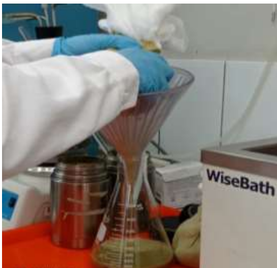
Figura 13. Filtrado del líquido ruminal a través de cuatro capas de gasa para la preparación del inóculo
