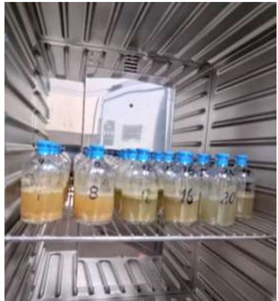
Figura 16. Incubación de los tratamientos experimentales para la determinación de la digestibilidad de la materia orgánica
