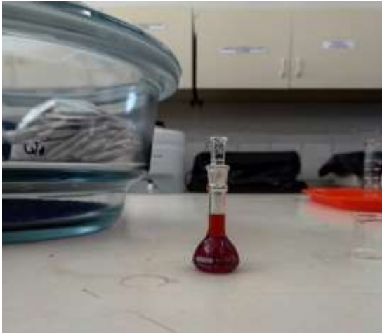
Figura 11. Dilución de los taninos de semilla de uva en agua des ionizada para la cuantificación de fenoles
