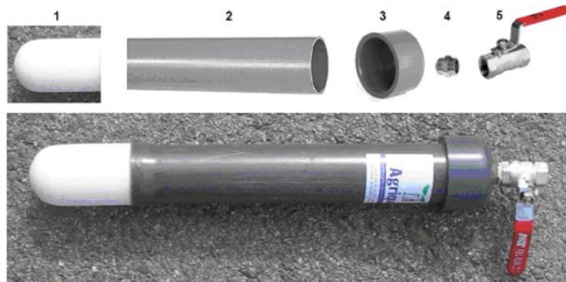
Figura 22. Partes de sondas lisimétricas, 1. Cápsula cerámica, 2. Tubo rígido de PVC, 3. Tapón de PVC, 4. Machón de acero, 5. Válvula de esfera y prototipo de lisímetro vacío.
