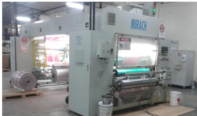
Figura 4: Laminadora de adhesivo con y sin solvente
