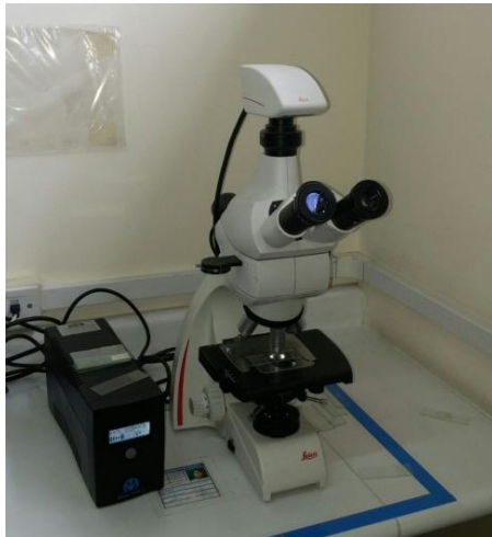
Figura 36: Microscopio óptico Leica DM 750M
