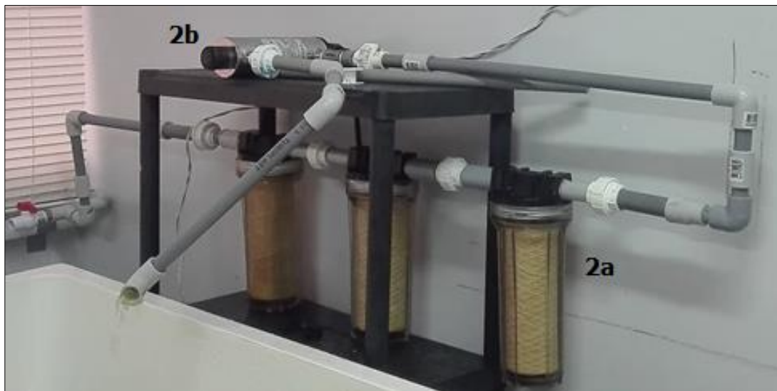
Fotografía 4. Sistema de filtrado y esterilización UV. a). Sistema de filtros de agua de mar (10, 5 y 1 \mu m). b). Lámpara UV.
