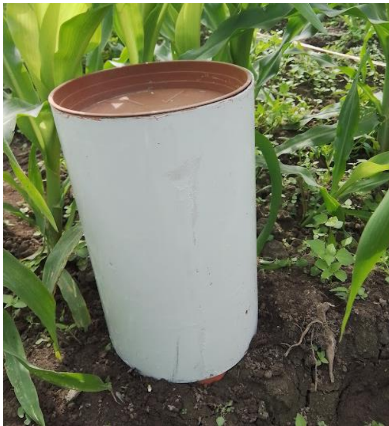
Figura 9: Colector semiabierto estático instalado en el campo
