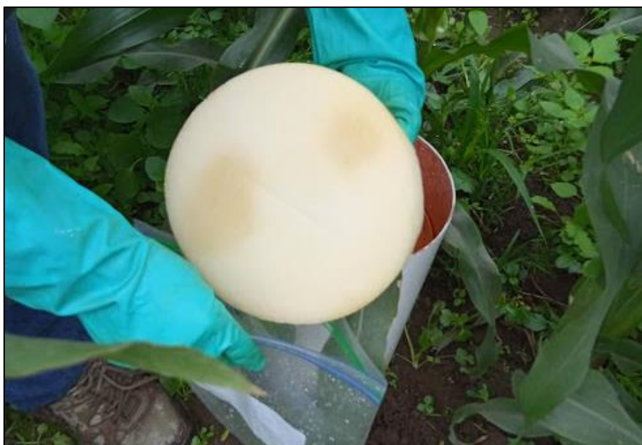
Figura 6: Extracción de discos de poliuretano después de recolectar el amoníaco volatilizado por 24 horas
