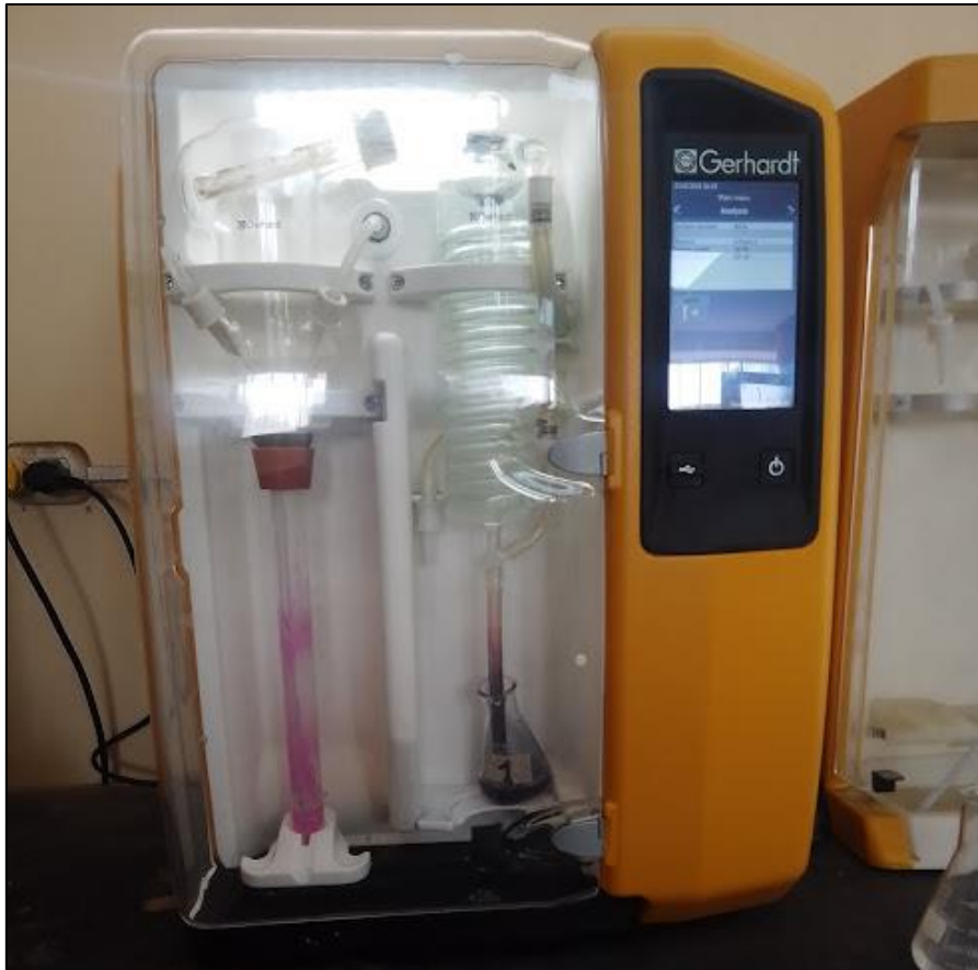
Determinación del contenido de nitrógeno con el equipo de la destilación automática
