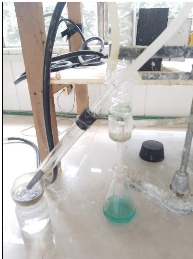
Destilación de las muestras foliares para determinar nitrógeno
