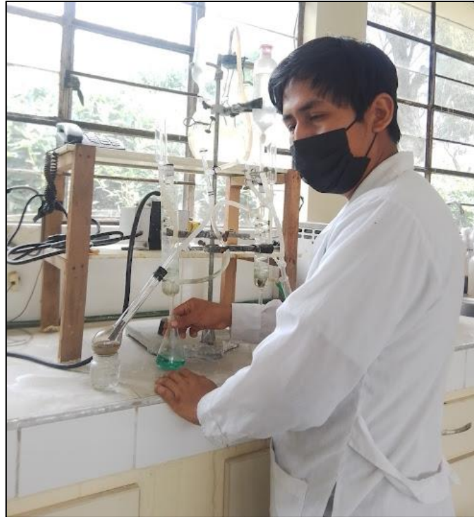
Determinación del contenido de nitrógeno foliar
