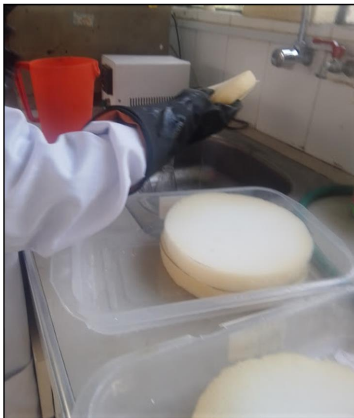
Lavado de esponja con agua desionizada, ácido fosfórico e hidróxido de potasio
