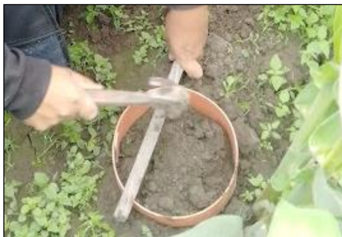
Figura 4: Instalación de las bases de los colectores semiabierto estático
