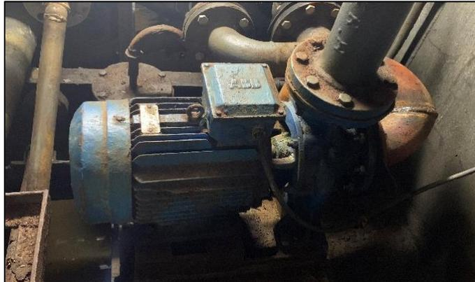
*Nota:* Foto de sala de máquinas de proa de la embarcación Huacho Cinco, donde figura la bomba de achique de las bodegas.
