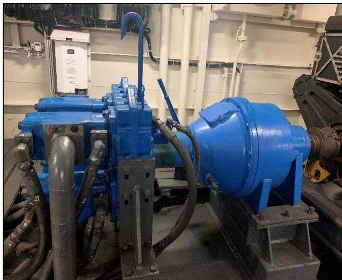
*Nota:* Foto de la planta hidráulica acoplado al motor C18, en sala de maquinas de la Huacho Cinco.
