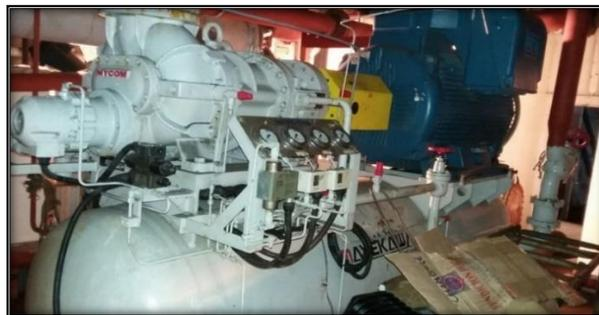
*Nota:* Foto de sala de máquinas de proa de la embarcación Huacho Cinco, donde figura el compresor del sistema de frío.
