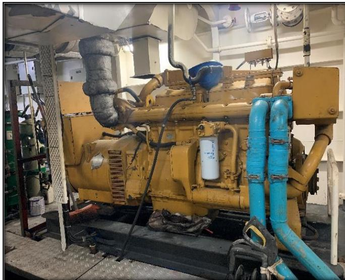
*Nota:* Foto del Grupo electrónico 3406 instalado en la embarcación Huacho cinco.
