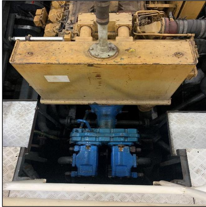
*Nota:* Foto de la planta hidráulica acoplado al motor principal, en sala de máquinas de la Huacho Cinco.
