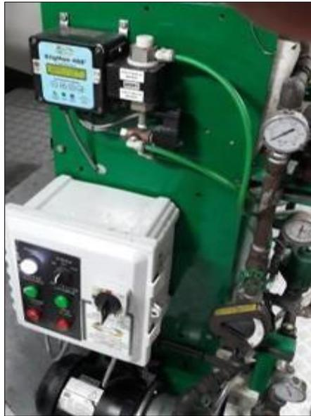
*Nota:* Foto del equipo de separación de hidrocarburos adquirido para la embarcación Huacho cinco.
