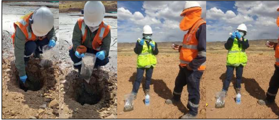
Figura 29: Medición in situ del pH del relave minero.
