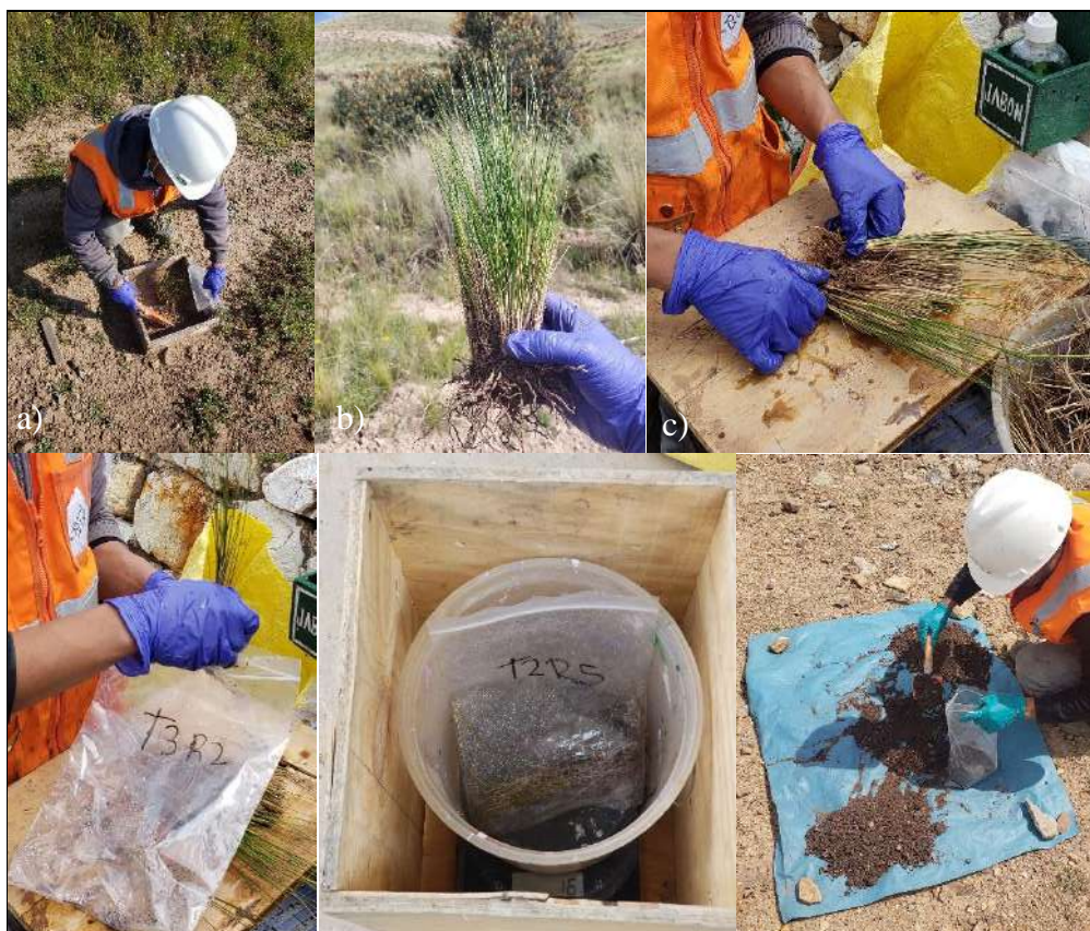
Figura 24: Recolección y evaluación de muestras finales. a) Extracción de planta. b) Planta extraída. c) Separación de la parte aérea y radicular de la planta. d) Almacenamiento de las muestras de tejido vegetal. e) Obtención del peso fresco de las muestras de tejido vegetal. f) Obtención de muestras sólidas de los tratamientos.
