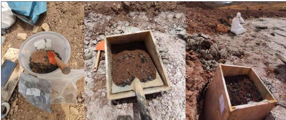
Figura 18: Llenado de celdas experimentales en el área experimental de relave minero.
