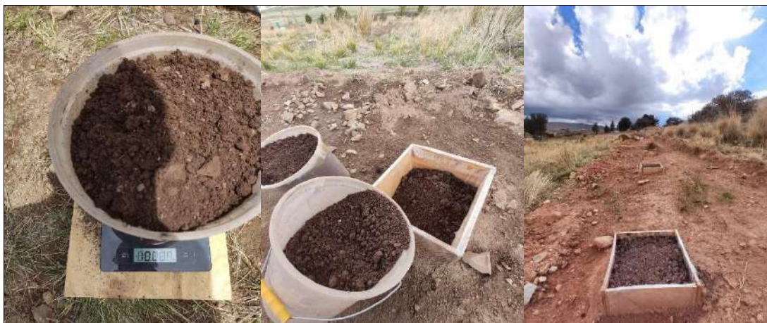
Figura 19: Llenado de celdas experimentales en el área experimental de referencia.
