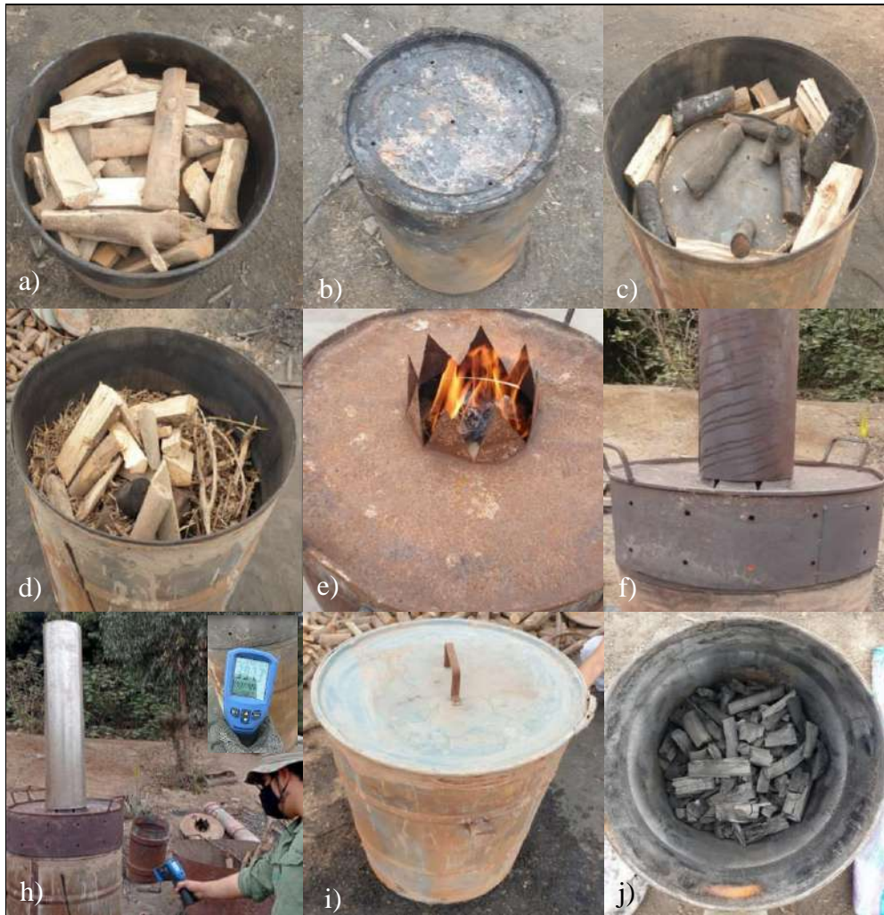
Figura 09: Producción de biochar. a) Llenado del tambor interior. b) Tapado del tambor interior. c) Llenado del tambor exterior para el soporte del frente de calor. d) Colocación de material para iniciar el frente de calor. e) Inicio del frente de calor y colocación de la corona. f) Colocación de la chimenea. h) Monitoreo de la temperatura alcanzada. i) Enfriamiento del tambor interior. j) Obtención del biochar.
