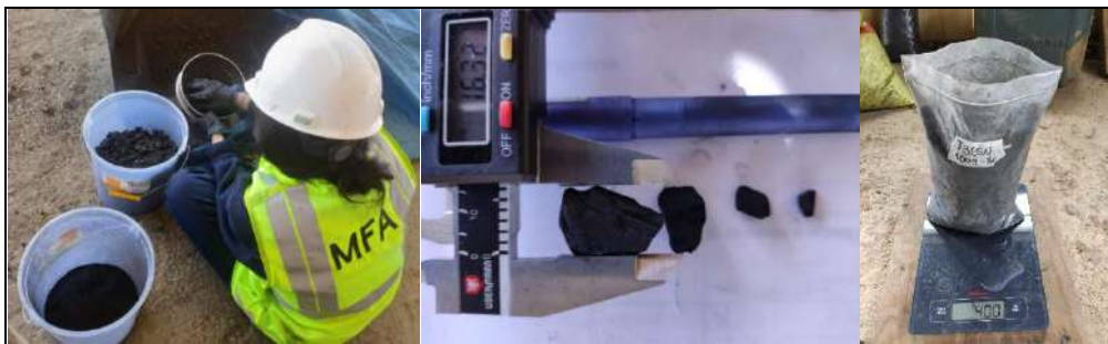
Figura 10: Tamizaje (izquierda), medición (centro) y dosificación (derecha) de biochar.
