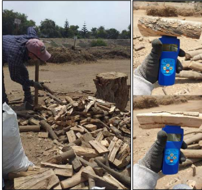
Figura 07: Acondicionamiento de los residuos de la poda y control de la humedad
