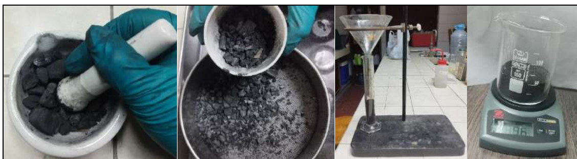
Figura 11: Determinación de la densidad aparente del biochar.
