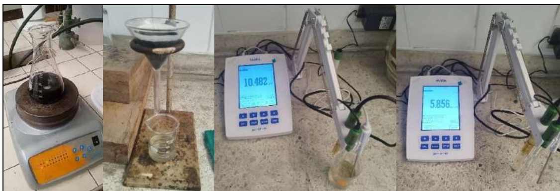
Figura 12: Determinación del pH y conductividad eléctrica del biochar.
