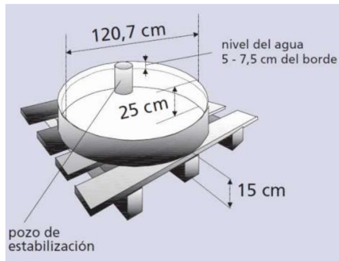
Figura 4: Características del tanque clase A
