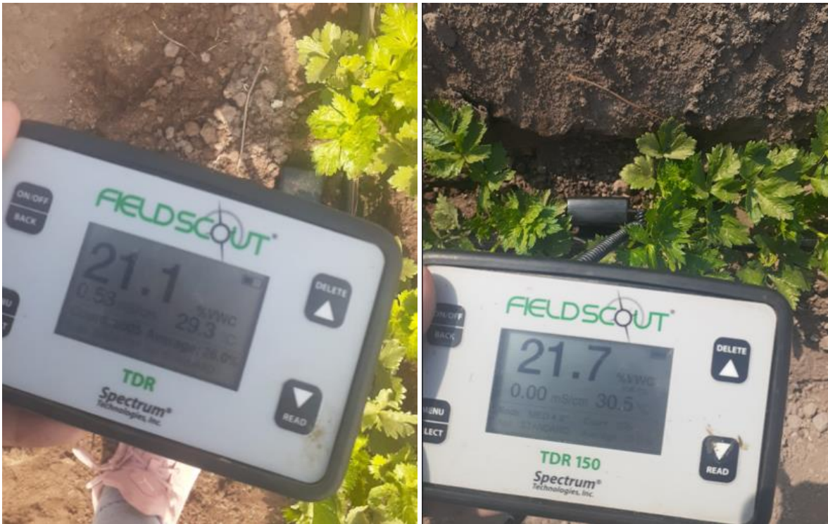
Figura 53: Control de la humedad
