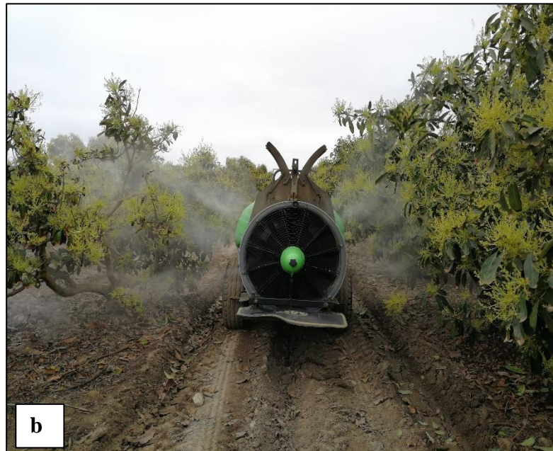
Figura 6: Imágenes del primer día de aplicación. a) preparación de mezcla Welgro Mar Crema Ecolicitor. b) Aspersión foliar mecanizada con tractor y turbina.
