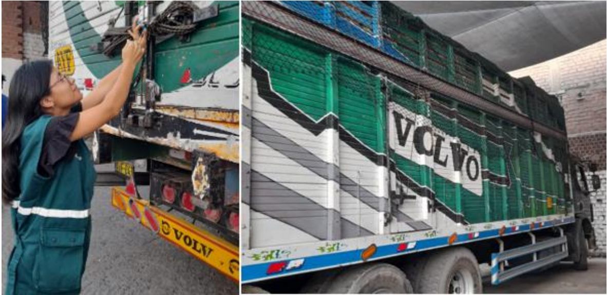
Figura 10: Izq. Proceso de precintado con soga. Der. Unidad resguardada con malla y soga
