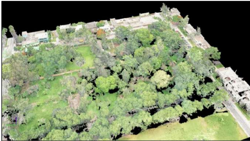
Figura 47: Reconstrucción tridimensional en color natural (izquierda) y MDS (derecha) del tratamiento C1 (Altura de vuelo 80 m - Ángulo de cámara:45°)
