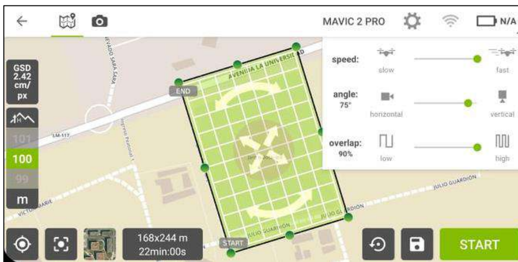
Figura 31: Interfaz de edición de parámetros de vuelo de Pix4D capture 4.8.0
