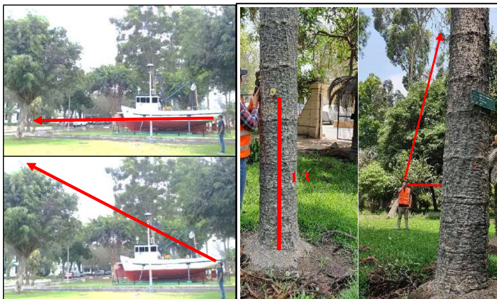
Figura 44: Medición de altura de árboles con Vertex IV
