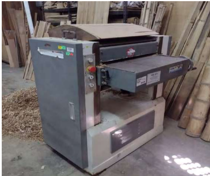
Figura 18: Cepilladora de superficies de las caras internas y externas de las latas de Dendrocalamus asper
