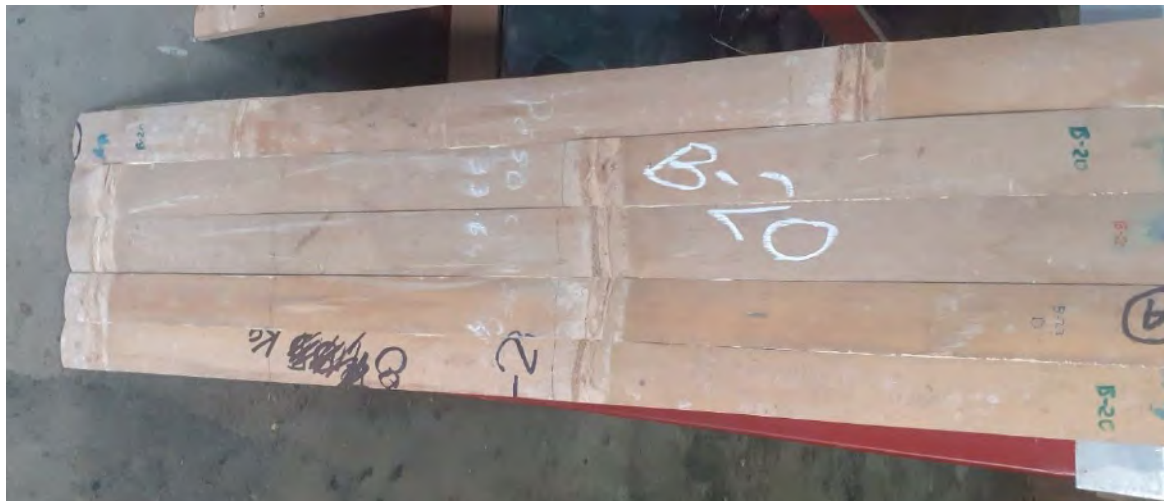
Figura 25: Paneles encolados lateralmente con cuatro líneas de cola
