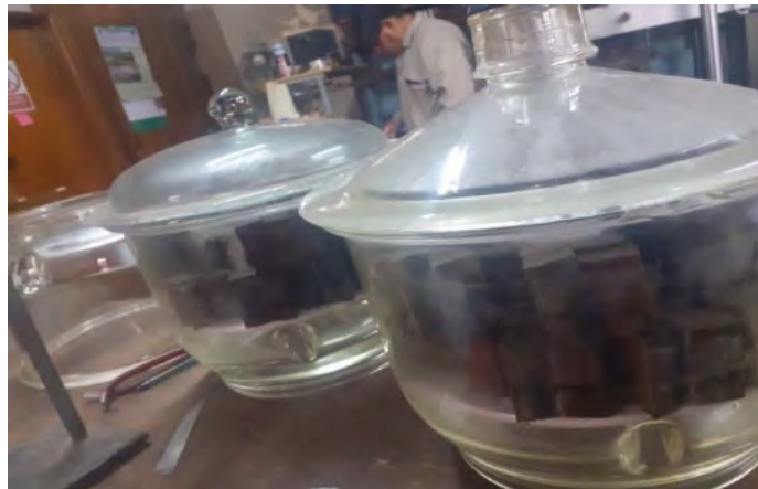
Figura 33: Probetas con pretratamiento uso en húmedo sumergidas en agua fría para enfriamiento
