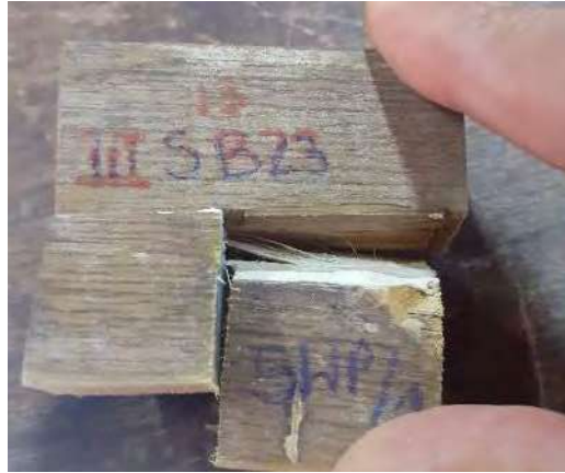
Figura 39: Probeta de bambú cizallada
