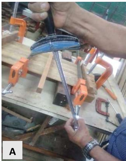
Figura 24: (A) Torquímetro para estandarizar la presión de prensa y (B) Prensado de latas de Dendrocalamus asper
