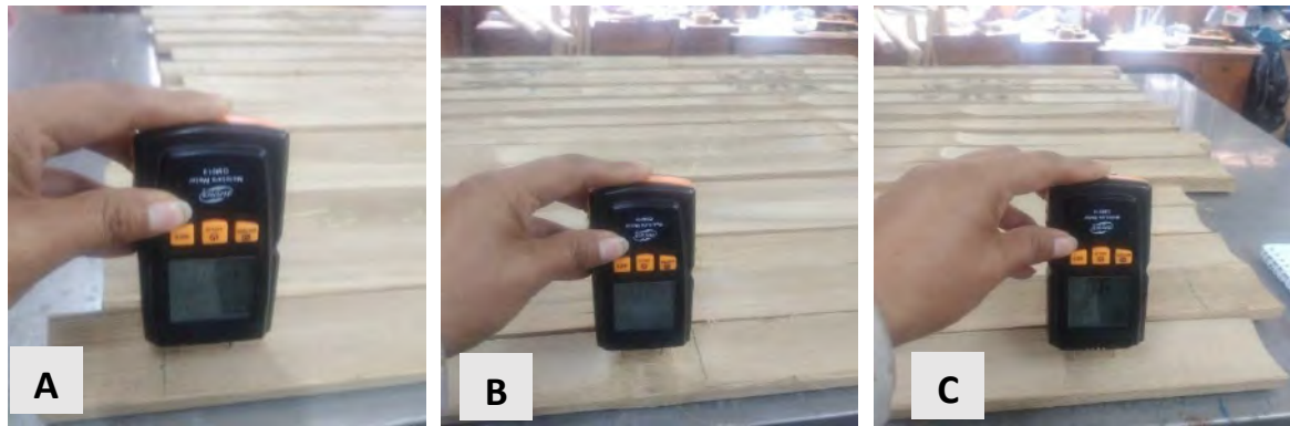
Figura 20: Determinación del contenido de humedad. A y C. Medición de humedad en los extremos de la latilla. B. Medición de humedad en el centro de la latilla de Dendrocalamus asper
