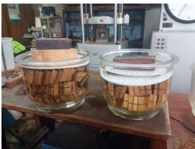
Figura 32: Probetas con pre tratamiento en uso en seco sumergidas en agua fría
