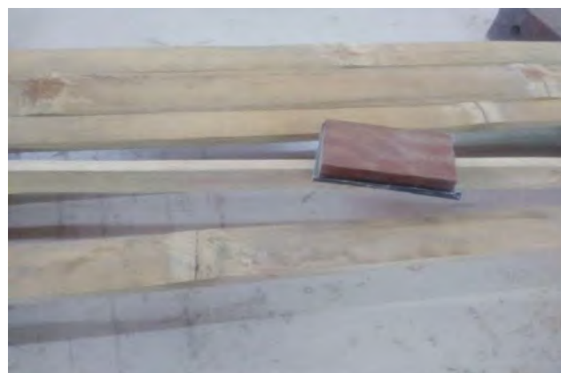
Figura 21: Lijado de los cantos de las latas
