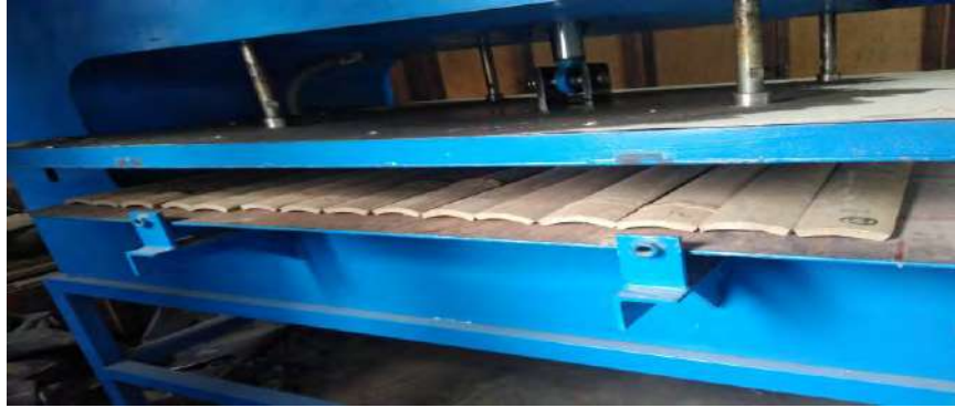
Figura 15: Prensado de latas de Dendrocalamus asper
