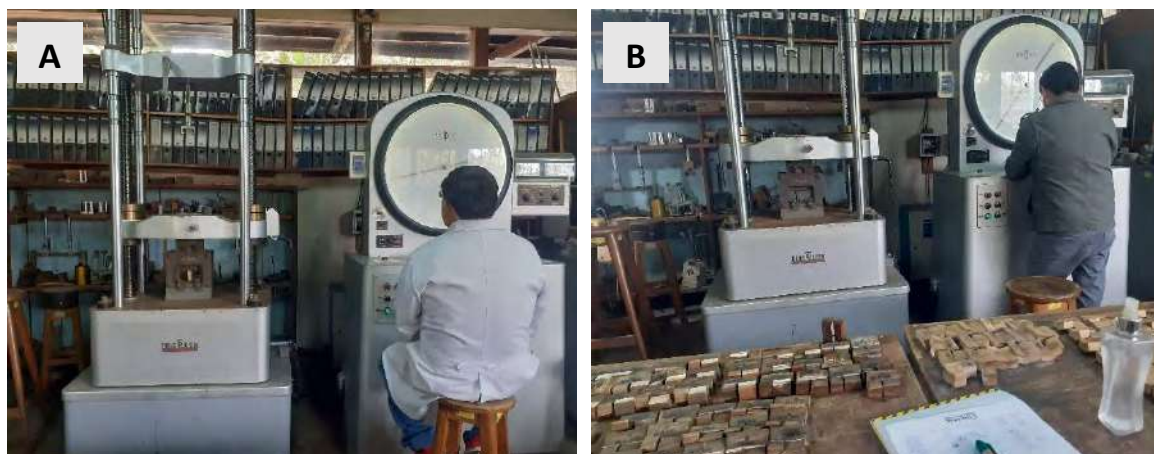
Figura 34: Uso de la prensa universal para la determinación de la resistencia al cizallamiento (A), lectura de resistencia al corte para el ensayo de cizallamiento (B)
