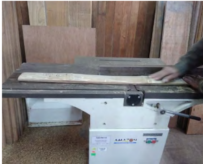
Figura 17: Garlopeado de cara interna de latas de Dendrocalamus asper
