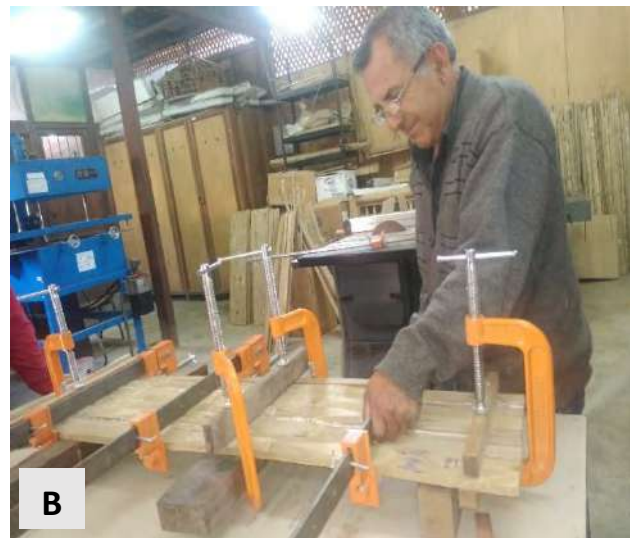
Figura 24: (A) Torquímetro para estandarizar la presión de prensa y (B) Prensado de latas de Dendrocalamus asper
