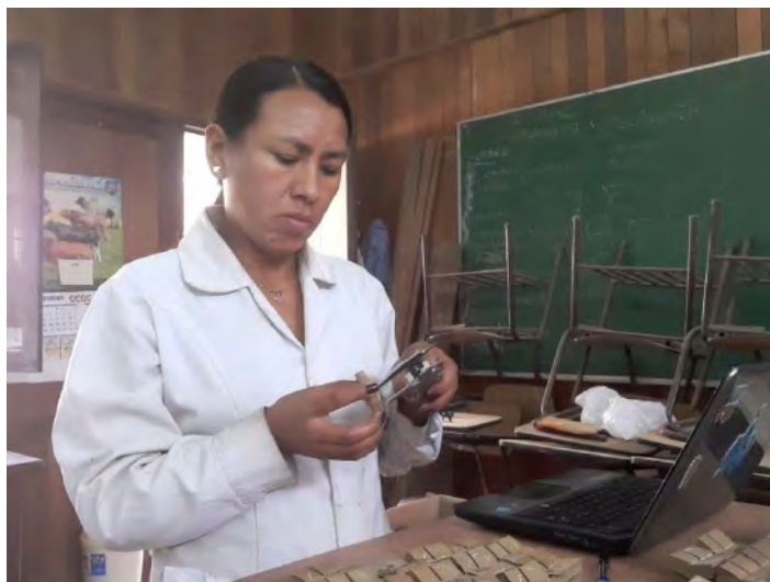
Figura 31: Medición y selección de probetas para sus pretratamientos de acuerdo con su uso
