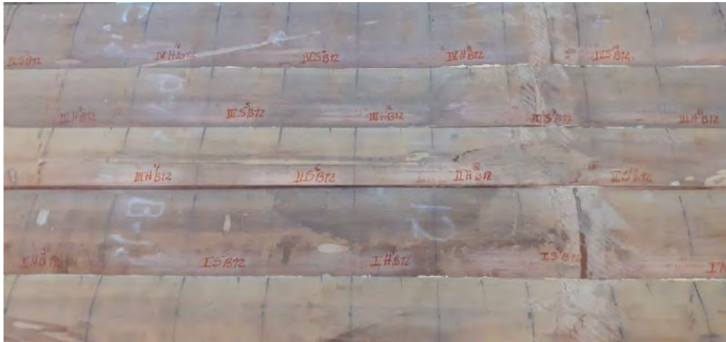
Figura 28: Distribución y codificación de probetas en el panel para los ensayos de cizallamiento
