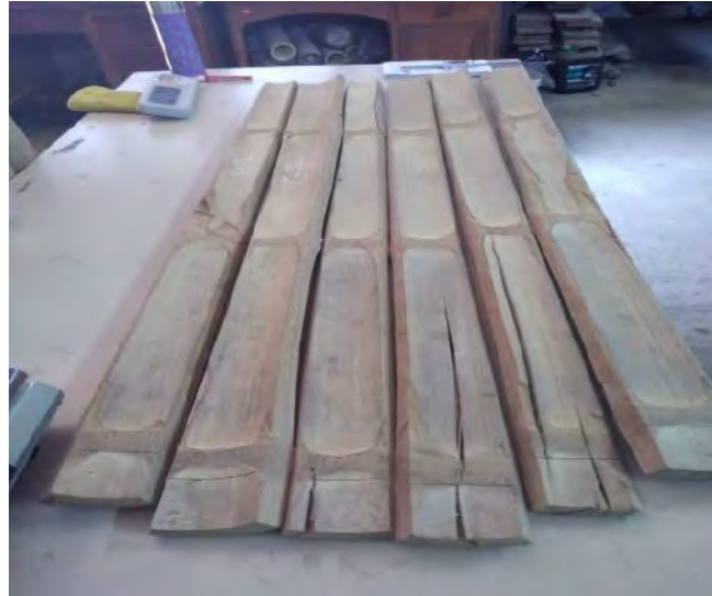
Figura 12: Latas defectuosas de la especie Dendrocalamus asper
