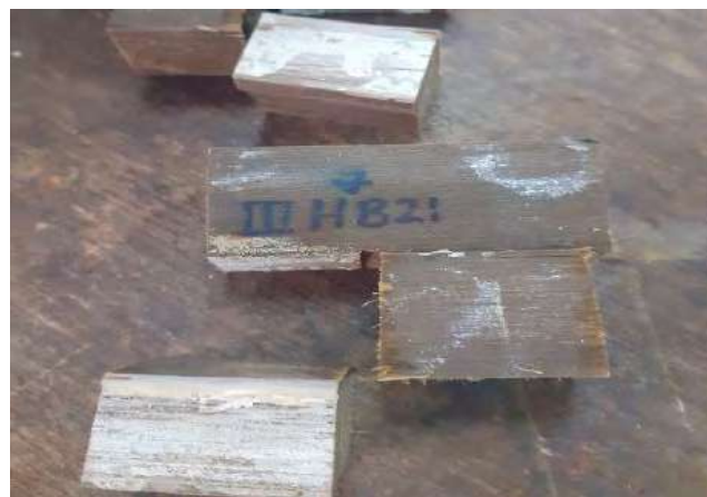
Figura 41: Probeta de bambú con ruptura en la línea de cola
