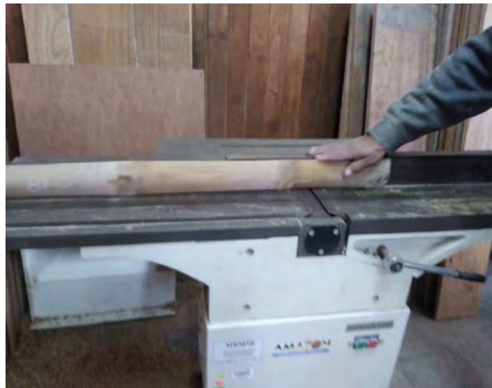
Figura 16: Garlopeado de cantos de latas de Dendrocalamus asper
