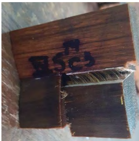
Figura 40: Probeta de bambú con ruptura en la parte parenquimática
