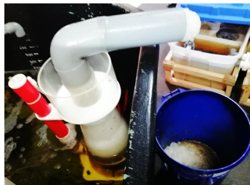
Un separador de sólidos de espuma ('skimer' en inglés)
