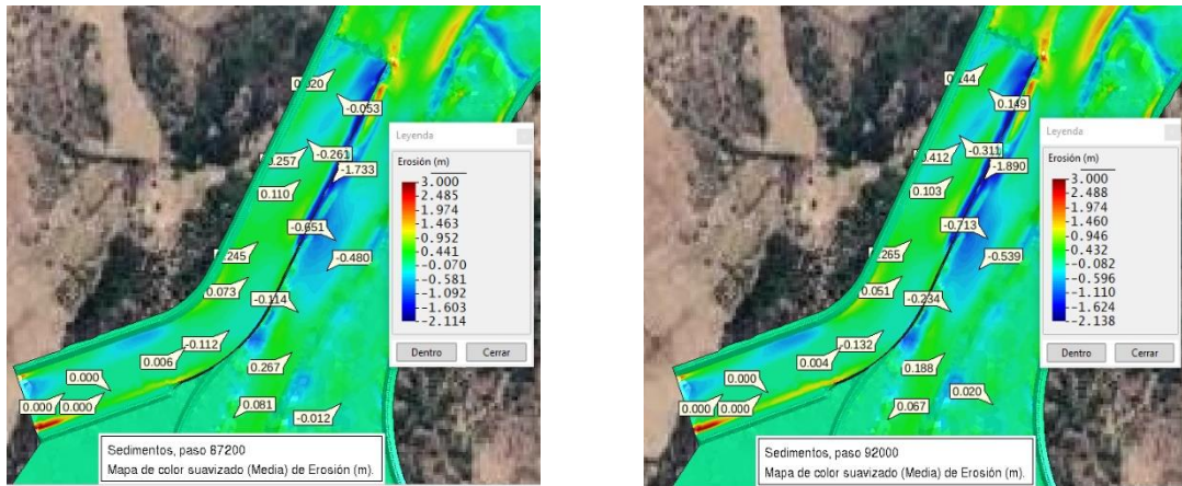
Figura 79: Evolución de erosión y sedimentación en el canal colector en sedimento en suspensión
