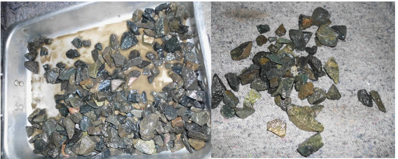
Figura N° 12: Secado del agregado grueso con paño
