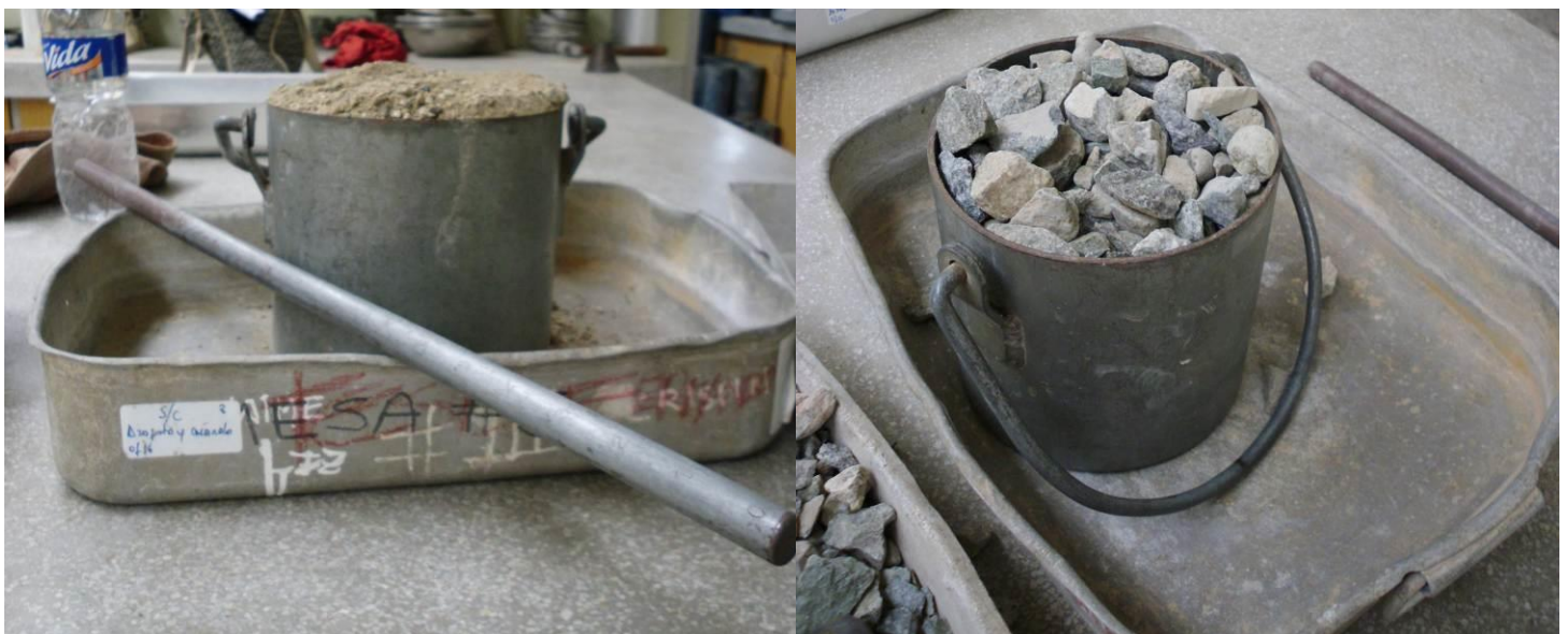
Figura N° 15: Recipientes llenos con agregado fino y agregado grueso
