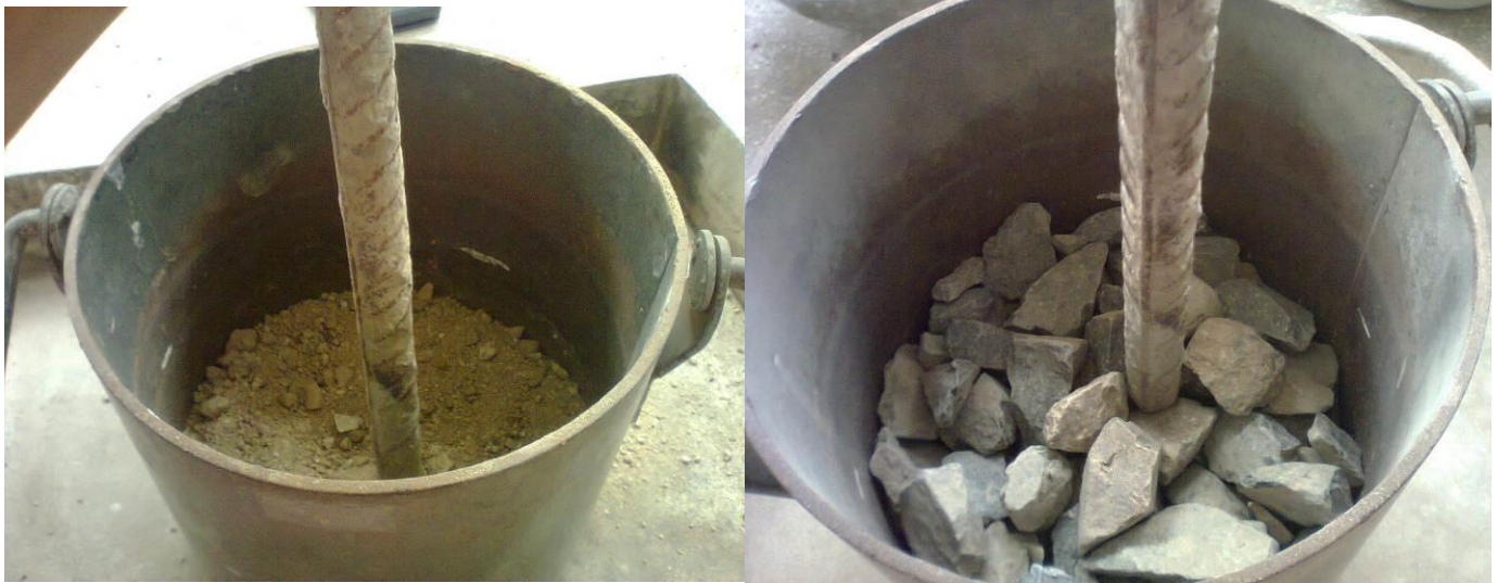
Figura N° 14: Compactación del agregado fino y grueso con ayuda de la varilla
