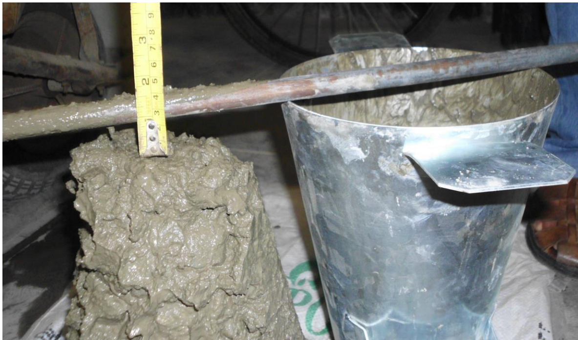
Figura N° 9: Medida del asentamiento con el Cono de Abrams
