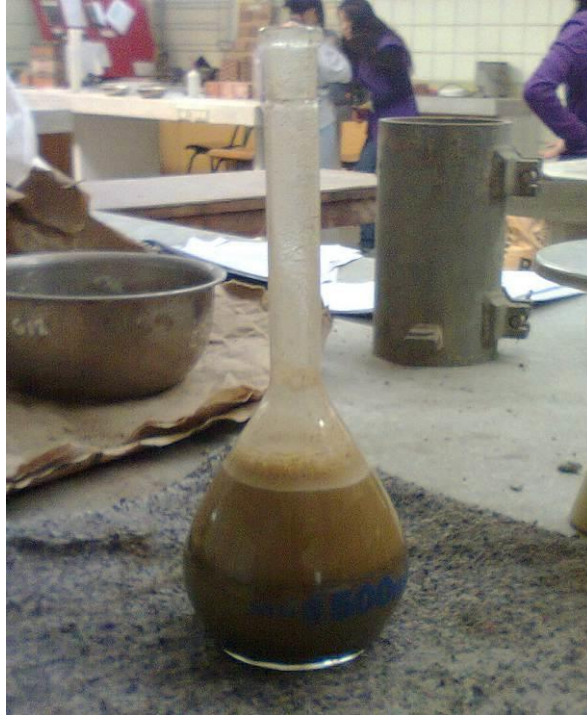
Figura N° 11: Picnómetro con agregado fino y agua
