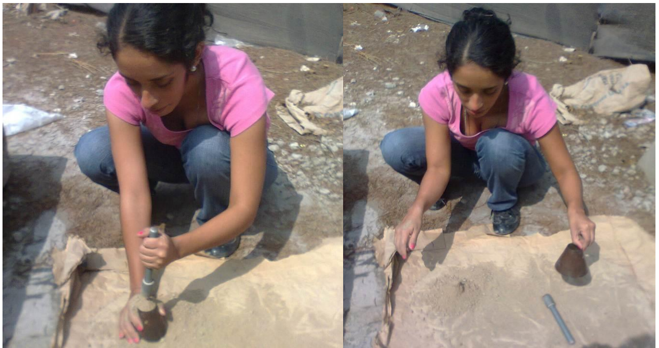
Figura N° 10: Muestra en estado saturado con superficie seca
