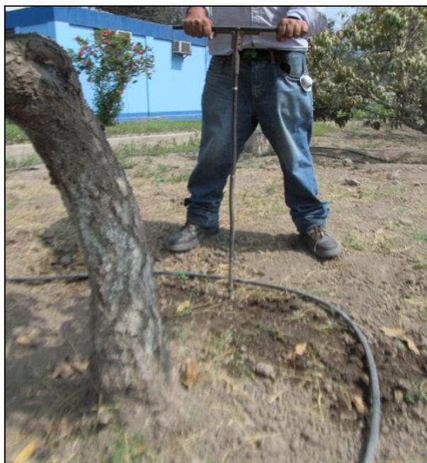
**Figura 8: Toma de muestra para la medición por el método gravimétrico**
